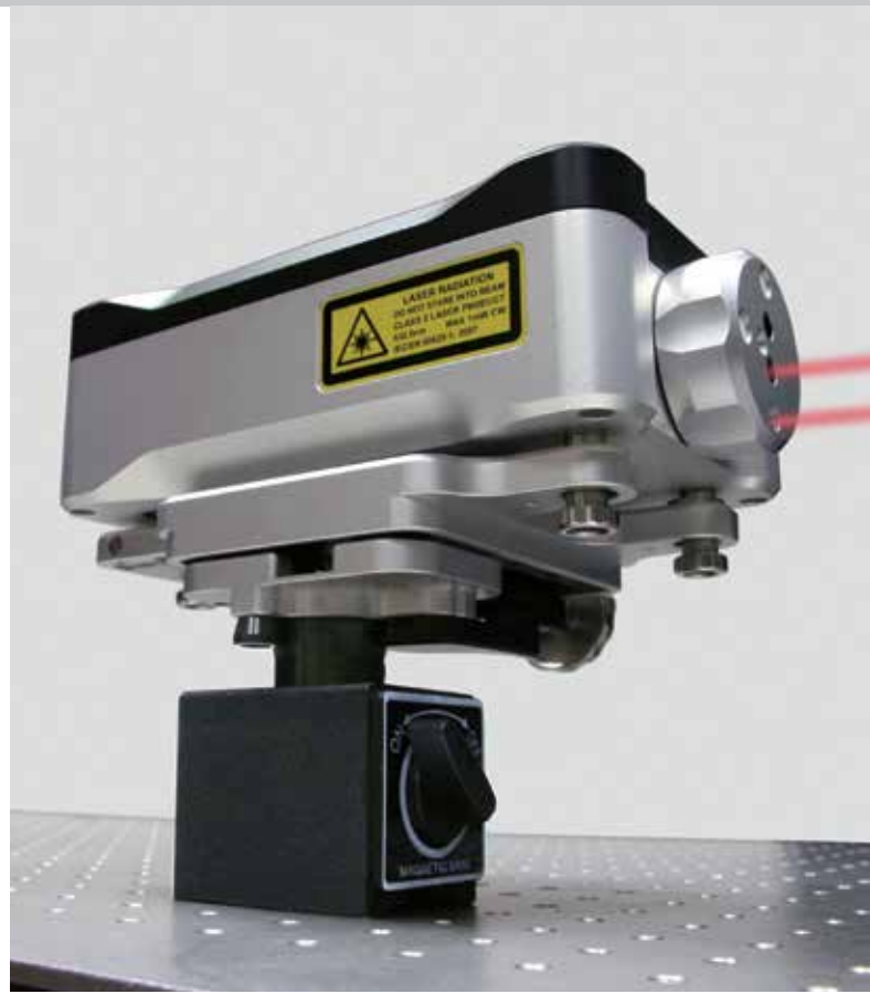
将XL-80激光系统安装到磁力表座上
