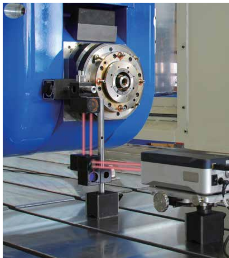
配备线性/角度组合光学镜组件的XL-80激光系统
