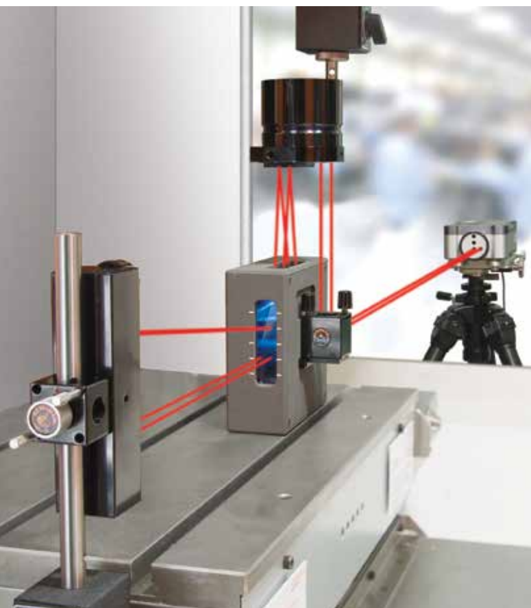
在一个垂直轴上进行垂直度测量
